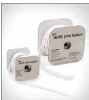
A vedação original que pode ser moldada no local é a alternativa mais versátil e econômica para vedações em lâmina para flanges de equipamentos grandes. Ideal para vedar superfícies complexas, ela se adapta extremamente bem a superfícies ásperas ou esburacadas. Ela também é fácil de instalar: basta retirar a proteção posterior, aplicar à superfície e sobrepor as extremidades para obter uma vedação altamente firme.
